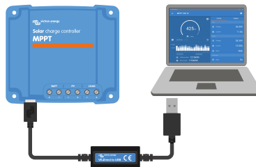
De VictronConnect-app verbinding via USB door gebruik te maken van een VE.Direct USB-interface
