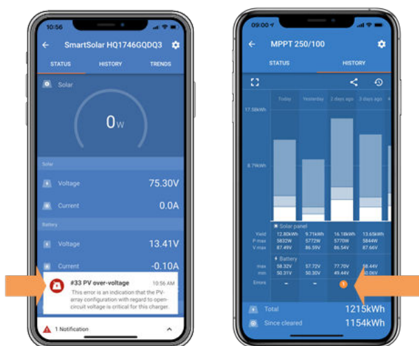
VictronConnect: schermafbeelding van een fout #33 en een schermafbeelding van de historie die een fout aangeeft
